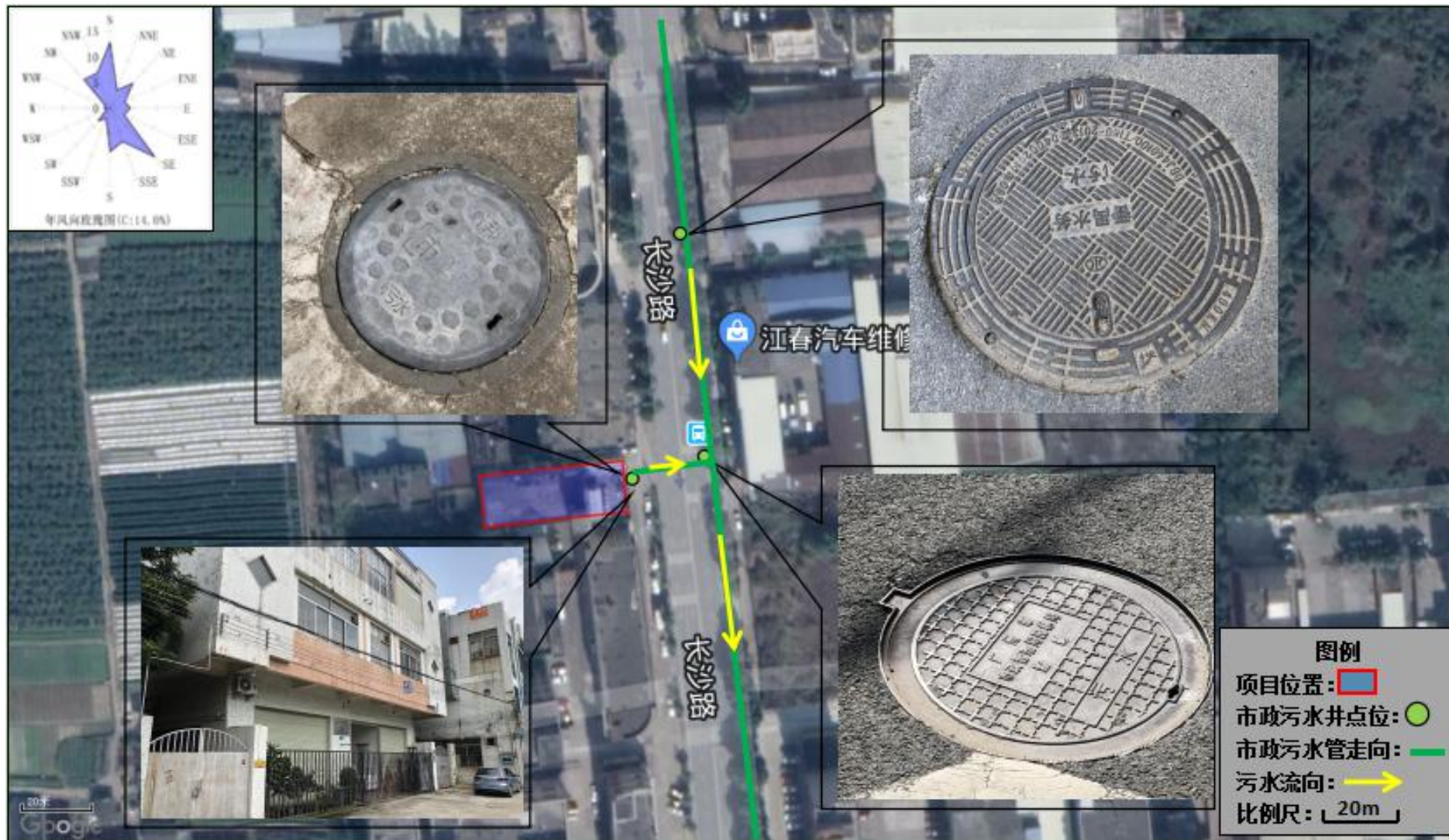
附图12 污水管网及接驳位置图
