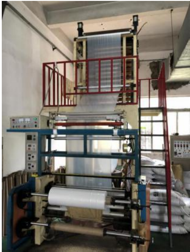
项目车间（吹塑工序）
