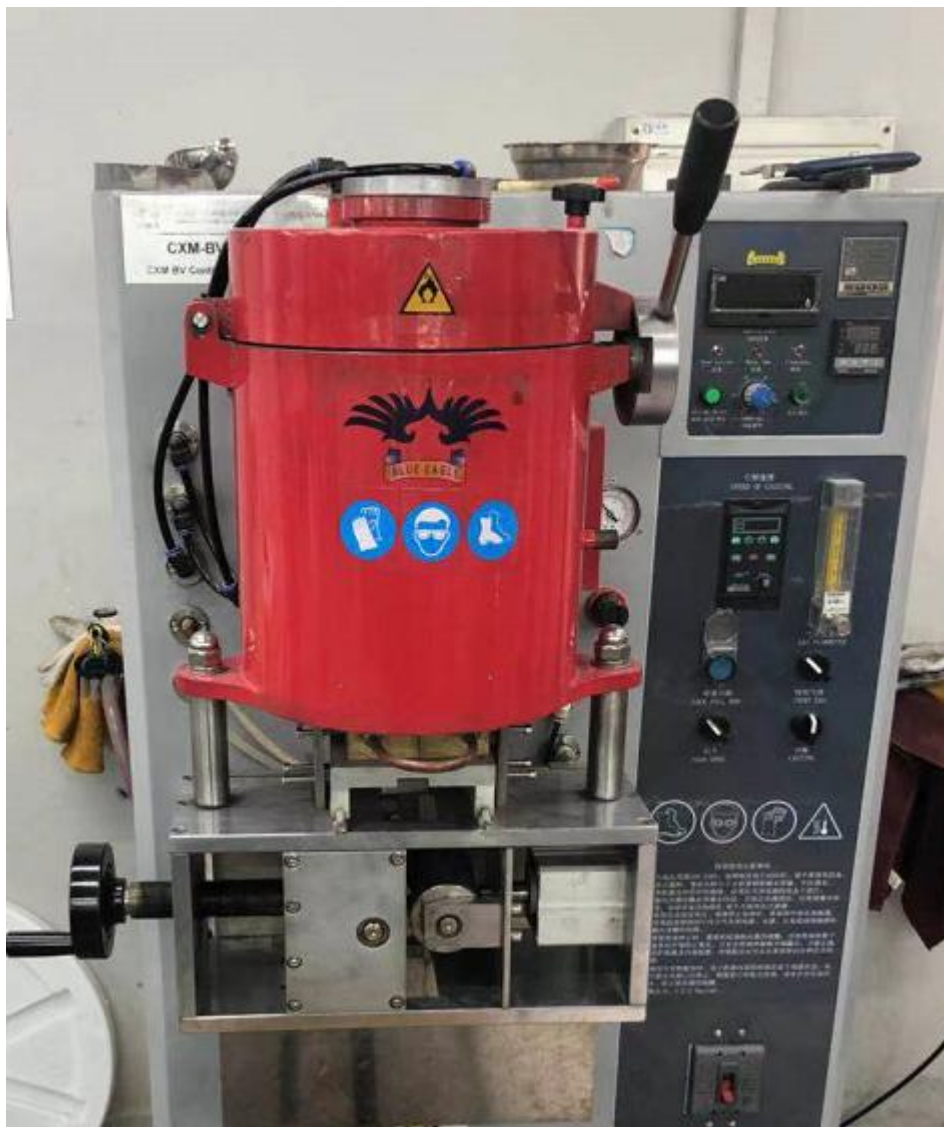
图 5-2 高频真空电熔炉图
