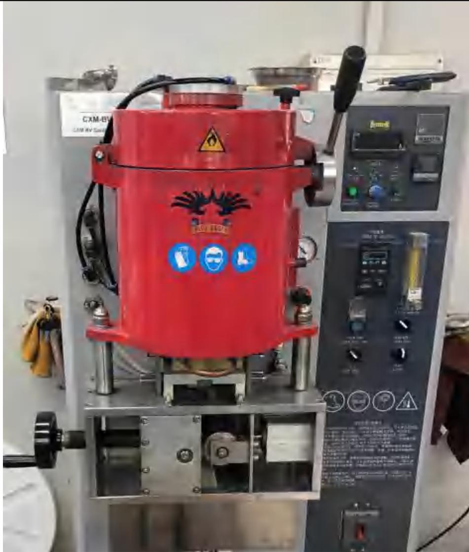
图 2-2 高频真空电熔炉图
