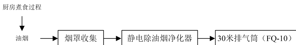
图3-4 项目废气处理流程图
