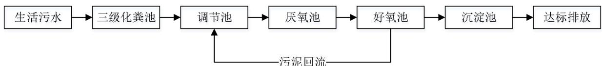
图 4-2 项目生活污水处理工艺流程图
