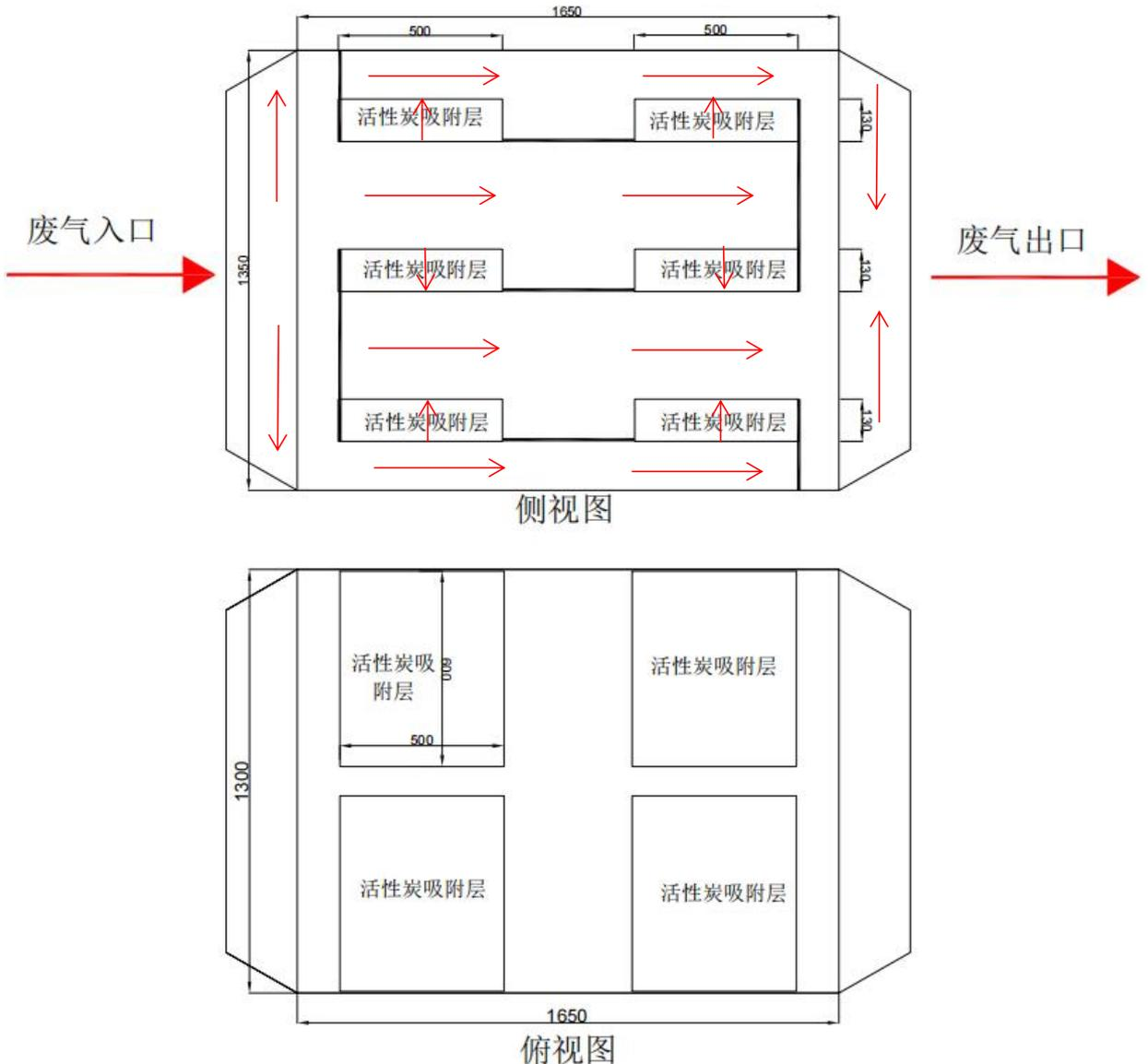
图 4-5 活性炭吸附器内部结构和气流走向示意图
