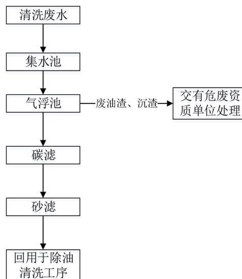
图 4-3 项目清洗废水处理工艺流程图
