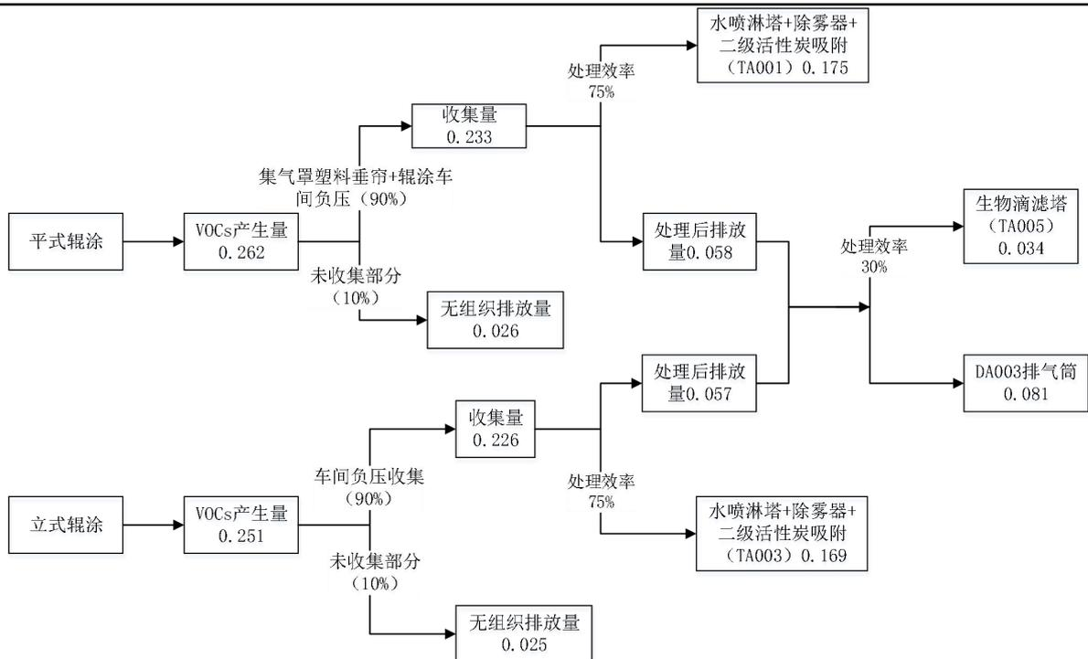
图2-2 全厂有机废气平衡图 (t/a)
