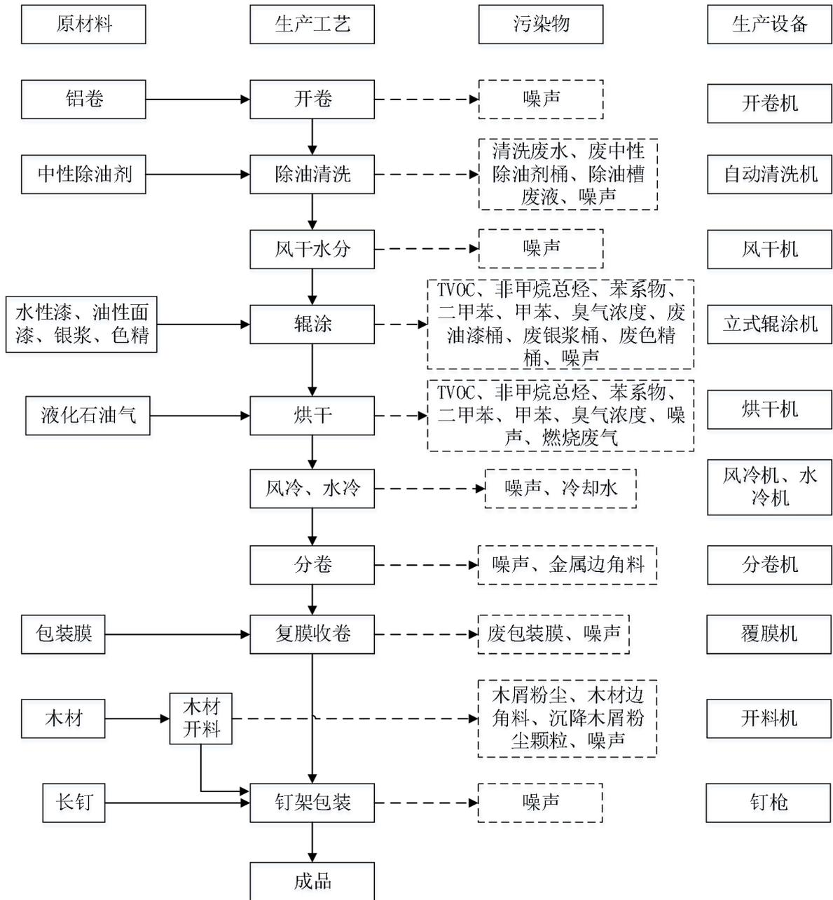
图 2-3 项目辊涂铝卷生产工艺流程图
