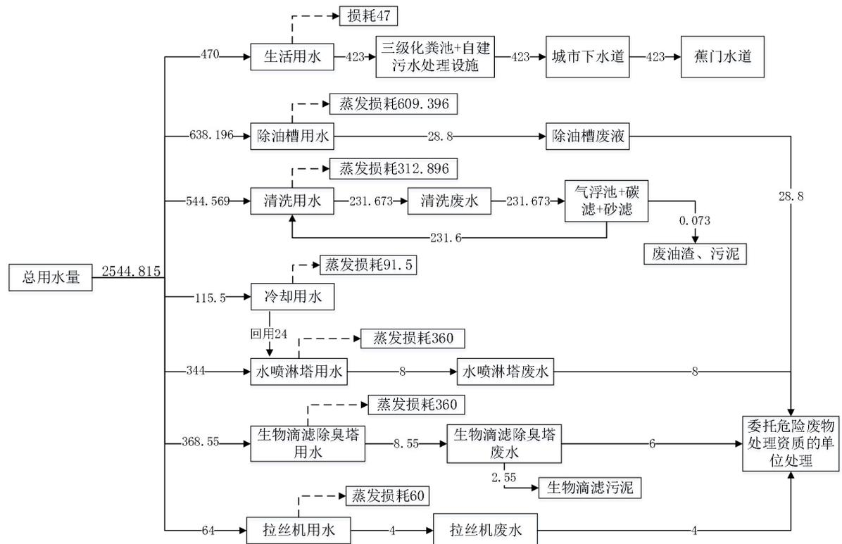
图 2-1 全厂水平衡图 (t/a)
