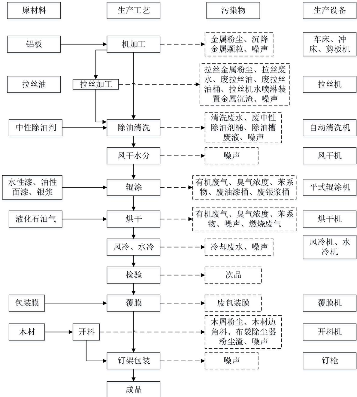
图 2-3 项目辊涂铝板生产工艺流程图
